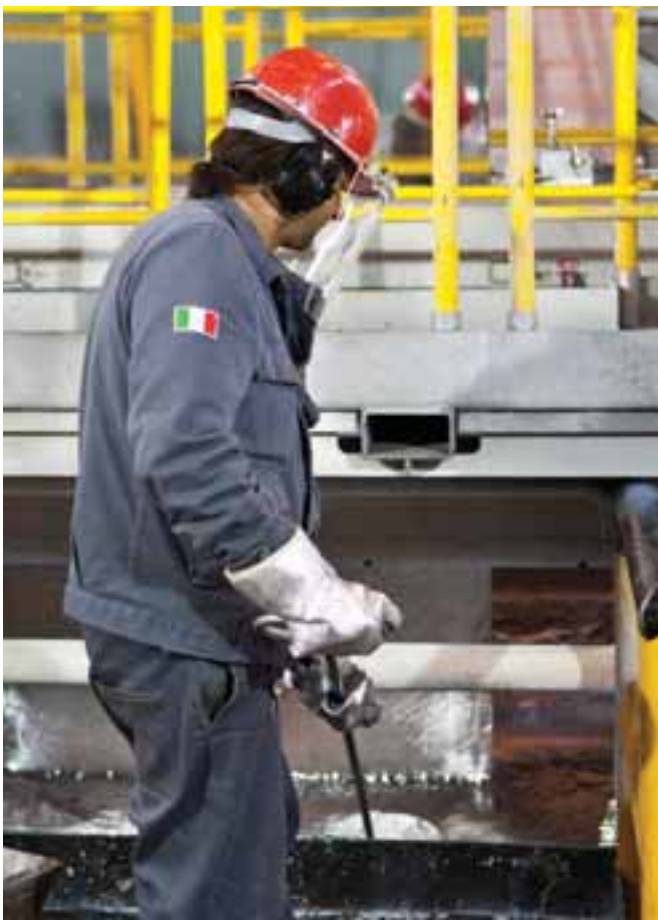
Figura 125 Operazioni presso la vasca zinco della zincatura a caldo
