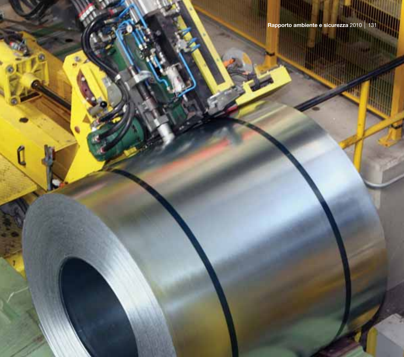
Figura 137 Operazione di marcatura di un coil
