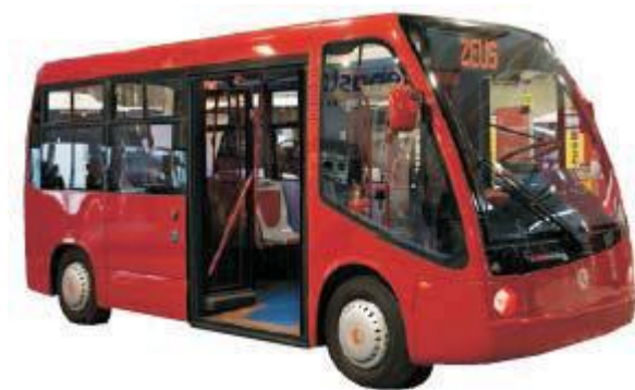
Ibrido (Idrogeno – Batterie) Minibus in collaborazione con Bredamenarini Spa
