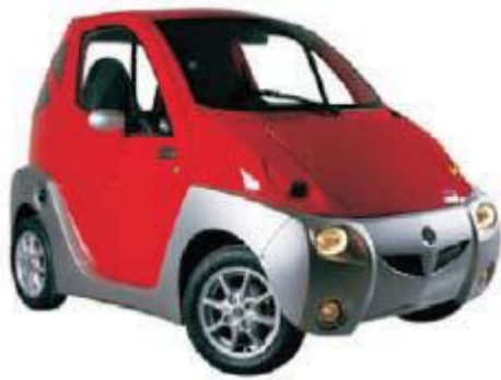
Veicolo ibrido a 2 posti (Idrogeno – Batterie) in collaborazione con AEE
