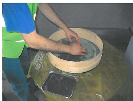
Foto 19 : Setacciatura manuale del compost finito
