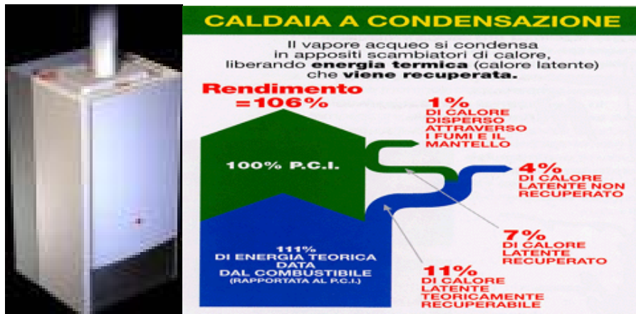
Figura 4.1 – Efficienza energetica delle caldaie a condensazione
