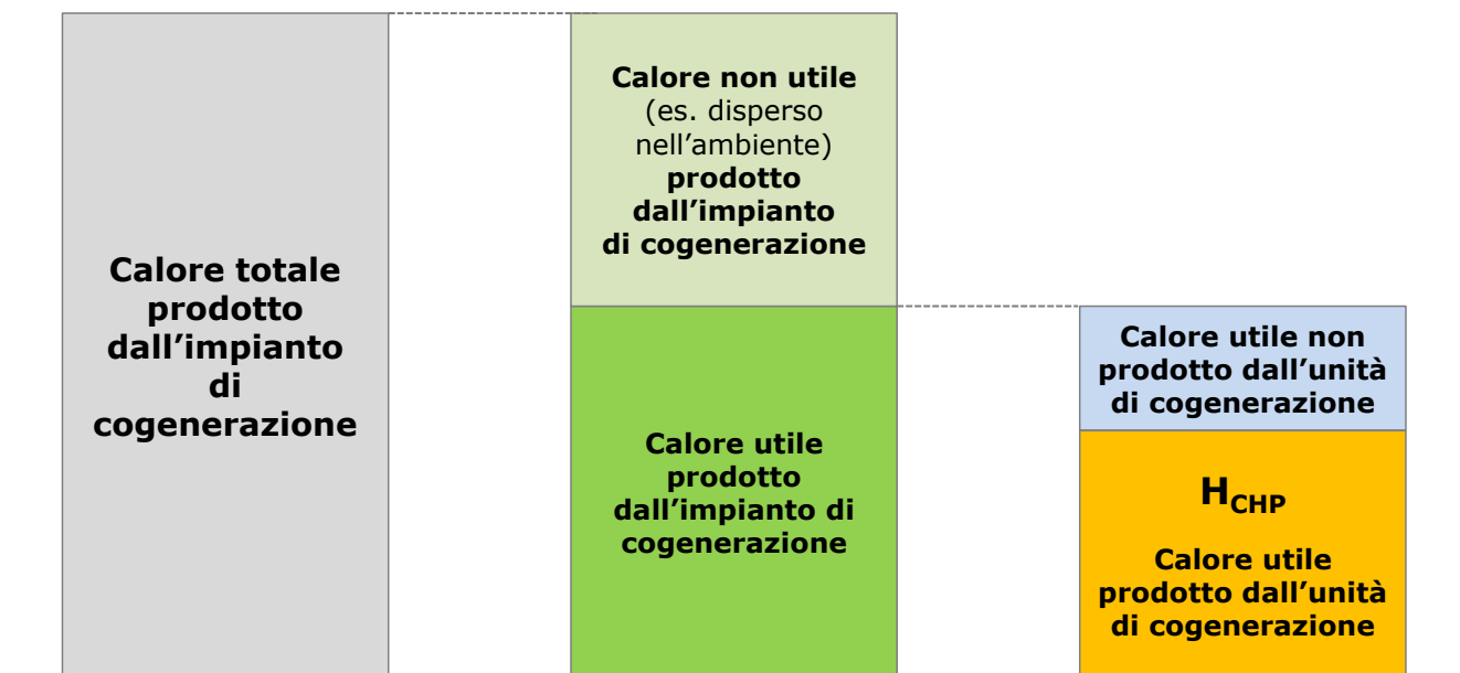
Figura 21 - Componenti del calore totale prodotto dall'impianto
