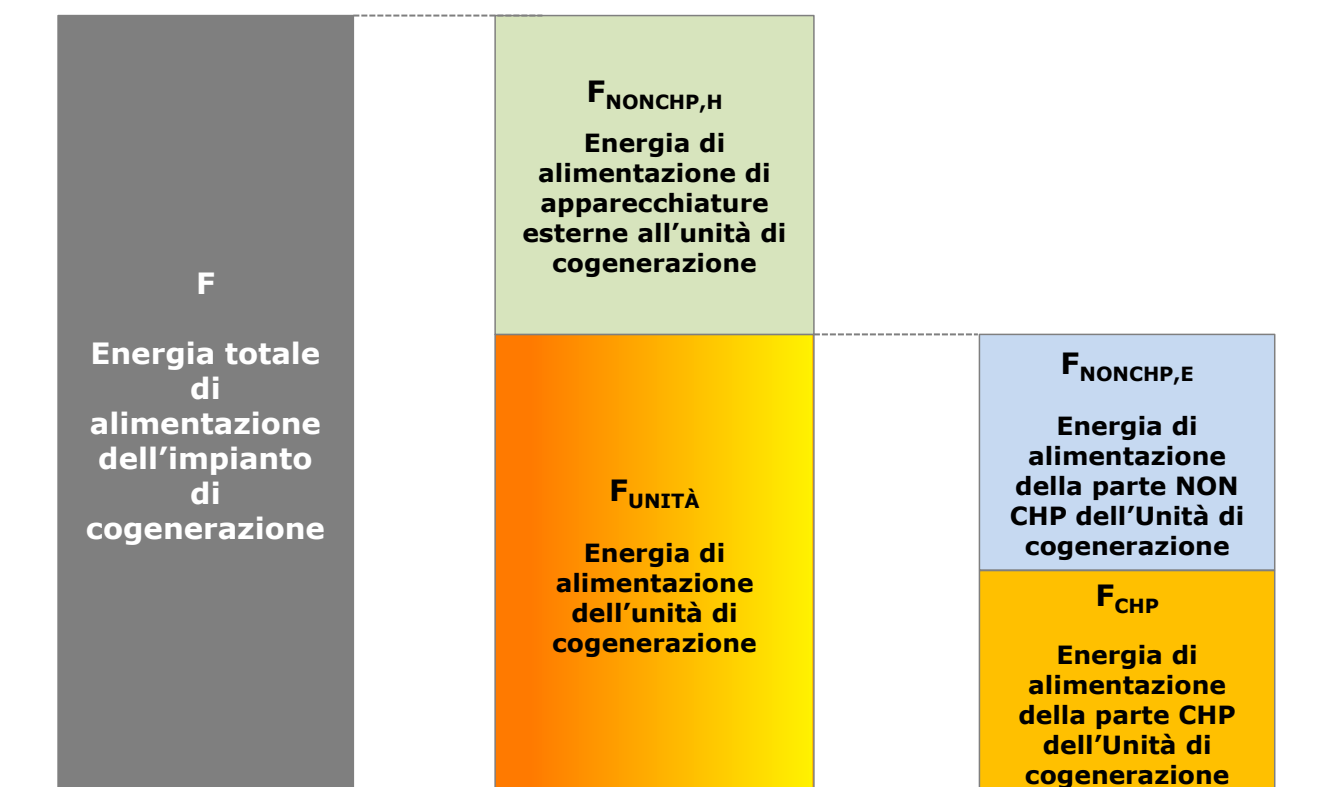
Figura 14 - Componenti dell'Energia totale di alimentazione dell'impianto
