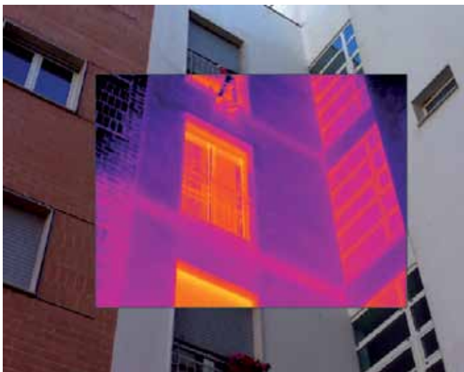
NAPOLI - SOCCAVO VIA CROCE DI PIPERNO ANNO 2008 PRESENZA DI PONTI TERMICI E INFILTRAZIONI >>
