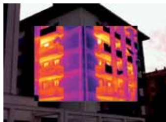
FIRENZE - VIA CANOVA ANNO 2010 EDIFICIO PUBBLICIZZATO CON PRESTAZIONI ENERGETICHE DI CLASSE A IN EVIDENZA I PONTI TERMICI DI TRAVI E PILASTRI PORTANTI
