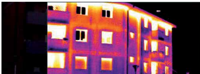
PADOVA - EDIFICIO RESIDENZIALE ANNO 2009 DISPERSIONI LOCALIZZATE SUL TELAIO PORTANTE >>
