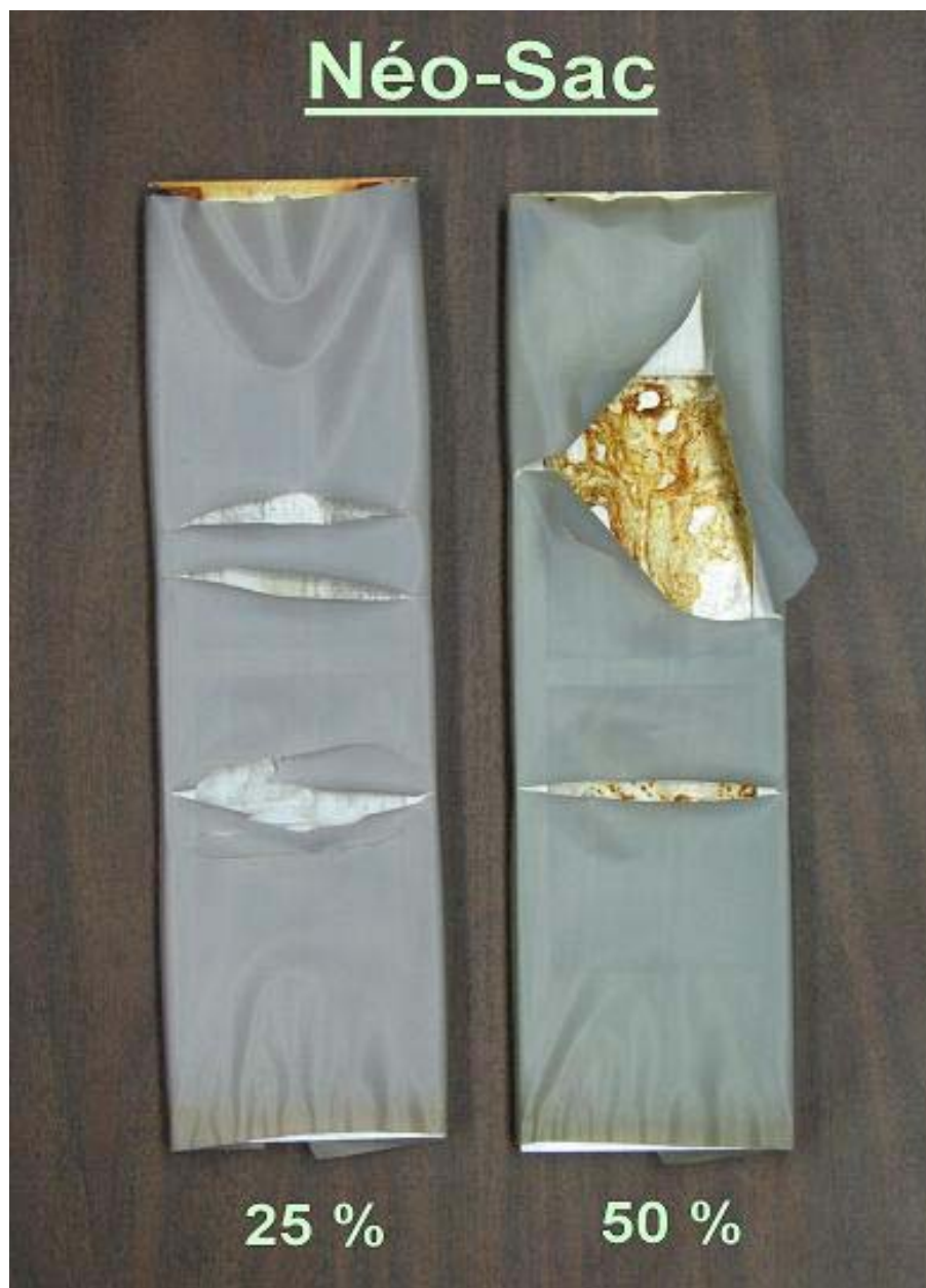
Figure 5 Pellicules contenant 25 % et 50 % de sacs « NéoSac » après sept jours d'exposition aux rayons UV dans une atmosphère chaude et humide
