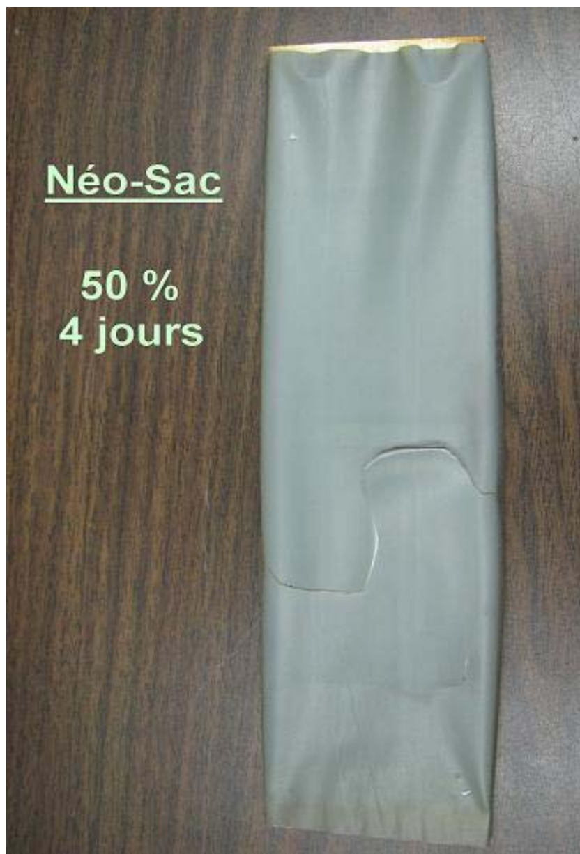
Figure 4 Pellicule contenant 50 % de sacs « NéoSac » après quatre jours d'exposition aux rayons UV dans une atmosphère chaude et humide
