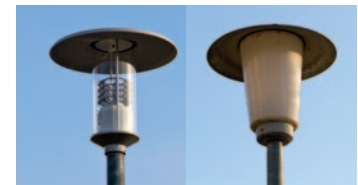
Pilzleuchten, ob neu oder alt, gehören wegen unzureichender Lichtlenkung und Abschirmung zu den schlechtesten Leuchten.
