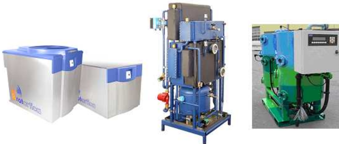
Figura 2.4a Esempi di piccoli condizionatori ad assorbimento che utilizzano l'acqua come refrigerante e bromuro di litio come fluido assorbente. Sinistra : condizionatori ad aria di potenza 4,5 kW della Rotartica (Spagna). Al centro : 10 kW di potenza per il condizionatore Sonneklima (Germania), dalla elevata efficienza a carico parziale e COP elevato. Destra : Condizionatore da 15 kW di potenza realizzato dalla compagnia tedesca EAW; questa macchina è disponibile anche nelle taglie da 30 kW, 54 kW, 80 kW e maggiori. Fonti: Rotartica, Sonnenklima, EAW.
