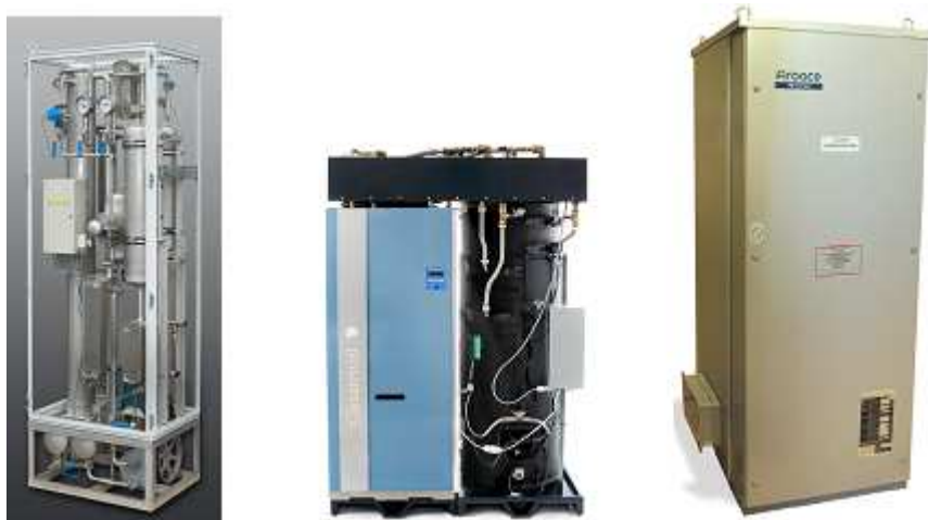
Figura 2.4b Altri esempi di macchine ad assorbimento. Sinistra : condizionatore ammoniac-acqua da 12 kW della compagnia australiana Pink. Al centro : questo condizionatore è ad acqua (fluido refrigerante) e cloruro di litio (fluido assorbente). Anche la fase cristallizzata del materiale assorbente viene utilizzata a volte, con degli effetti sull'accumulo di energia interno. Potenza di circa 10 kW; la macchina è realizzata da ClimateWell, Svezia, e può funzionare anche come pompa. Destra : Condizionatore ad assorbimento con fluidi di lavoro H_2O/LiBr e Potenza di 35 kW della Yazaki, Giappone. Questa macchina si trova spesso in impianti di raffreddamento solari, dato che è stata per anni il più piccolo condizionatore ad assorbimento disponibile in Europa, utilizzabile con calore solare. Attualmente un versione più piccola, 17,5 kW, della stessa casa è stata introdotta nel mercato europeo. Fonti: Pink, ClimateWell, Yazaki.
