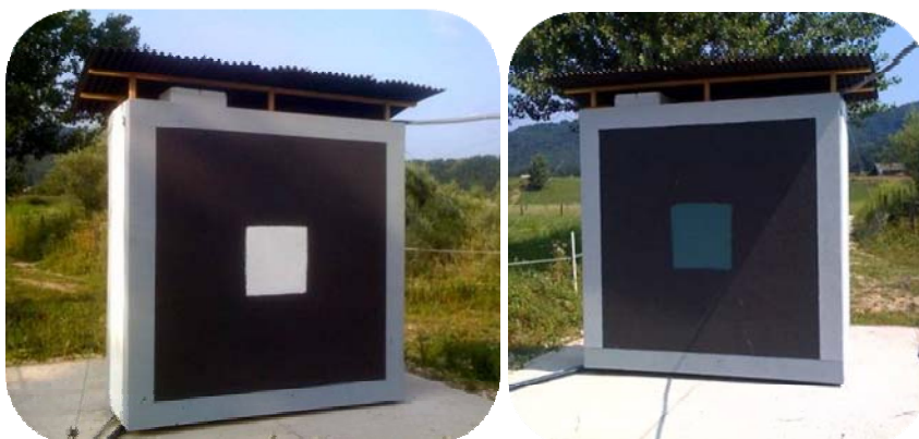
Figura 1.13 Una vernice selettiva aggiuntiva bianca (a sinistra) posta sotto un rivestimento verde (a destra) riduce il picco superficiale della temperatura fino a 15 °C.
