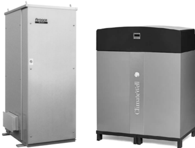
Figura 2.6b Altri esempi di refrigeratori ad assorbimento. A sinistra: refrigeratore ad assorbimento ad H_2O/LiBr con una capacità di 35 kW della Yazaki, Giappone. Questo refrigeratore si trova spesso nei sistemi di raffreddamento solare dato che, per diversi anni, è stato il refrigeratore più piccolo disponibile in Europa, utilizzabile con il calore solare. Ultimamente lo stesso produttore ha immesso, sul mercato europeo, una versione più piccola, di 17,5 kW. Fonte: Gasklima. A destra: questo refrigeratore usa acqua come refrigerante e cloruro di litio come materiale assorbente. La fase di cristallizzazione del materiale assorbente permette di effettuare un accumulo di energia interno. La capacità è approssimativamente di 10 kW; la macchina è stata sviluppata da ClimateWell, Svezia, è può funzionare come pompa di calore. Fonte ClimateWell.
