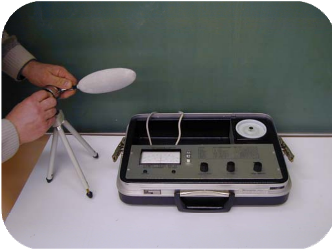
Figura 1.4 Strumento per la determinazione del voto medio previsto per ambienti interni (PMV); sensore di temperatura, misurazione di velocità e umidità dell'aria, tastiera per l'inserimento di met e clo.
