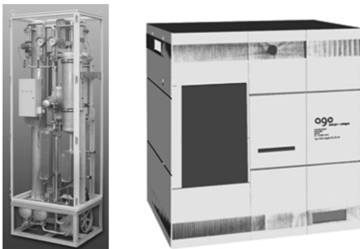
Figura 2.6c Esempi di refrigeratori ad assorbimento che utilizzano acqua ed ammoniaca come fluidi. In linea di massima, questi refrigeratori sono previsti per fornire acqua raffreddata a temperature < 0^{\circ}\text{C} per raffreddamento di tipo commerciale ed industriale, ma possono essere utilizzati per livelli di temperatura dell'acqua raffreddata più alti, sotto precise condizioni di funzionamento. A sinistra: refrigeratoro ad assorbimento con una capacità di raffreddamento stimata di 12 kW, sviluppato da Pink, Austria (senza involucro). A destra: refrigeratoro ad assorbimento prodotto da Ago, Germania. Questo refrigeratoro è disponibile con capacità a partire da 50 kW. Fonte: Pink/SolarNext.
