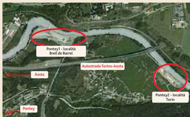
Presso il comune valdostano di Pontey si trova una centrale idroelettrica ad acqua fluente recentemente (2007) sottoposta a un'importante azione di rinnovamento. La centrale è costituita da due impianti situati lungo la sponda destra della Dora Baltea, poco distanti tra loro e collegati alla medesima linea elettrica.
